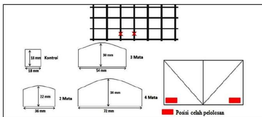
Gambar 2. Posisi pemotongan jaring (x), celah pelolosan yang terbentuk dan posisi penempatannya.
