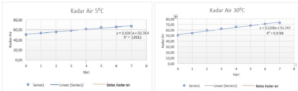
Gambar 5. Laju Perubahan Mutu Kadar Air Ordo 0 (Nol)
