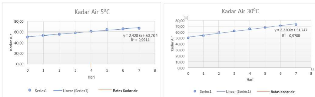
Gambar 5. Laju Perubahan Mutu Kadar Air Ordo 0 (Nol)
