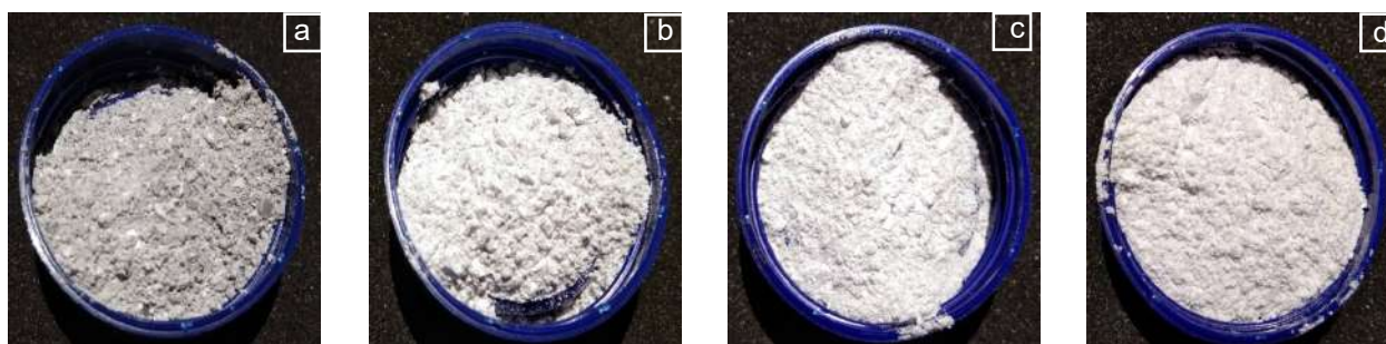
Gambar 1. Tepung CaO hasil kalsinasi tepung cangkang rajungan pada berbagai perlakuan suhu dan waktu kalsinasi; a. Perlakuan kalsinasi 700 °C selama 4 jam, b. 700 °C selama 5 jam, c. 800 °C selama 4 jam, d. 800 °C selama 5 jam
