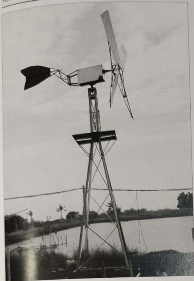
Kincir angin ini telah terpasang di tambak latih BAPPL-STP Serang, dan mampu menghasilkan energi listrik sekitar 500 watt. Kincir angin ini merupakan karya Taruna-Taruni BAPPL-STP beserta para dosen. Kincir ini sangat cocok untuk daerah kawasan pantai dan pulau terpencil yang belum memiliki sumber listrik.
