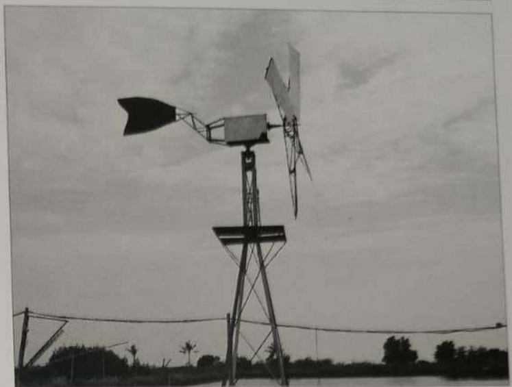
Kincir angin ini telah terpasang di tambak latih BAPPL-STP Serang, dan mampu menghasilkan energi listrik sekitar 500 watt. Kincir angin ini merupakan karya Taruna-Taruni BAPPL-STP beserta para dosen. Kincir ini sangat cocok untuk daerah kawasan pantai dan pulau terpencil yang belum memiliki sumber listrik.
