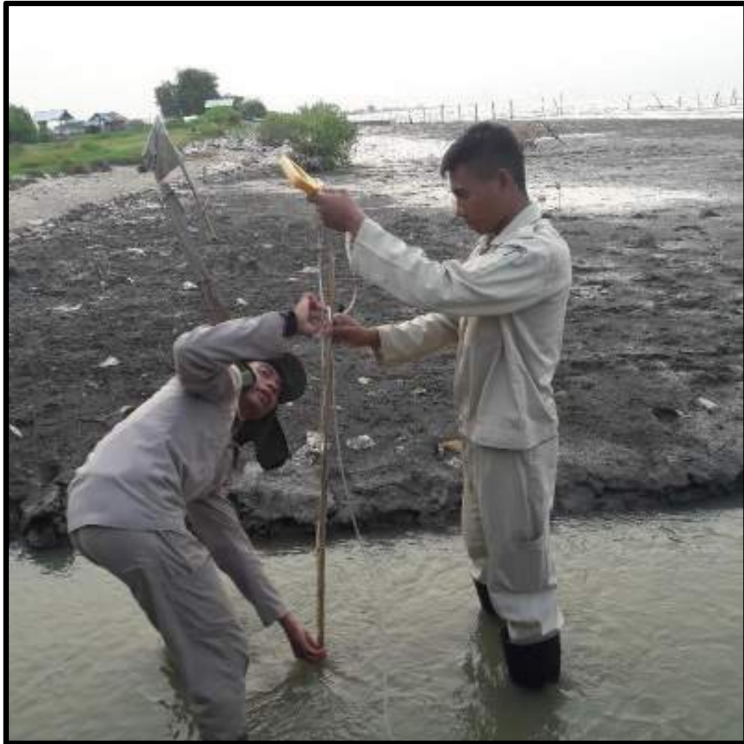
Gambar 7. Mengukur elevasi tambak dengan alat sederhana.
