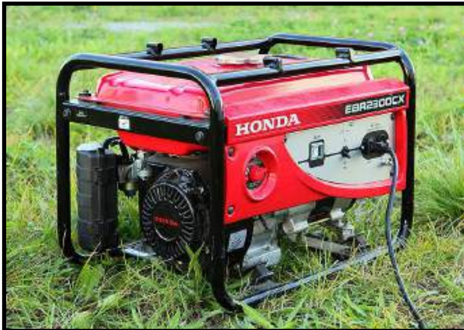
Gambar 24. Generator Set dengan Penggerak Motor Bensin
