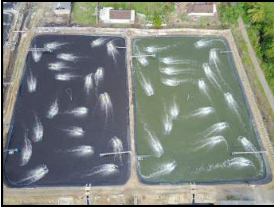
Gambar 34. posisi kincir pada tambak beton
