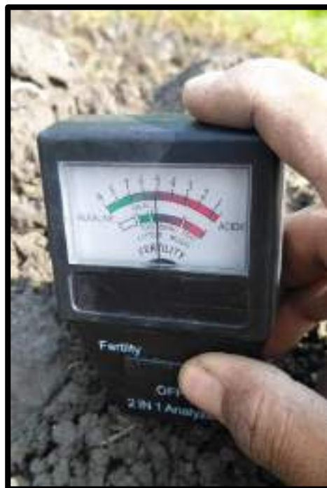
Gambar 16. Cara mengukur pH tanah dengan soil tester.
