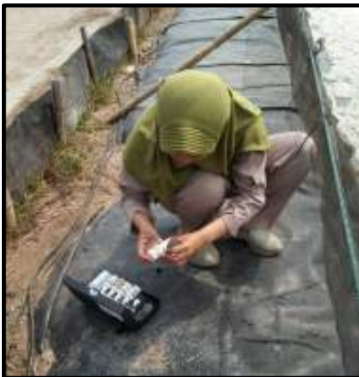
Gambar 1. Pengukuran oksigen terlarut menggunakan DO test kit.
