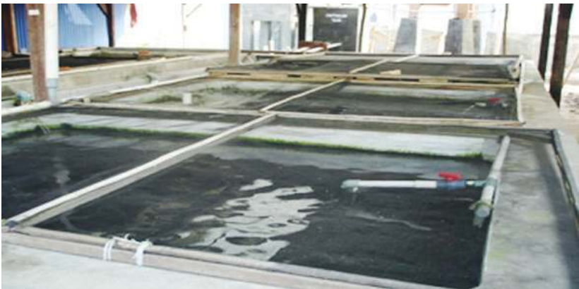
Gambar 3.3. Bak Beton yang digunakan untuk pemeliharaan induk dengan sistem tertutup ( closed system )
