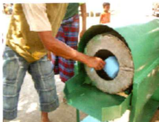
Pemasukan air garam ke dalam drum evaporator
